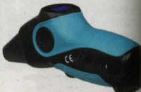
Digital lufttrycksmätare Praktisk lufttrycksmätare med bakgrundsbelyst LCD-display. Mätområde 0,3-6,8 bar. Visar trycket i bar, PSI, kPa eller kg/cm². Utskjutbar mätsticka för kontroll av mönsterdjup. Automatisk avstängning. Drivs av 2 x LR44-batterier (ingår).
