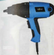
Mutterdragare Cotech 1/2" fäste. Maxvridmoment 450 Nm. Effekt 1010 W. Levereras med 4 krafthylsor: 17, 19, 21 och 22 mm samt väska. Vikt 3,6 kg.
