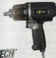
Mutterdragare Cotech 1/2" Vår starkaste mutterdragare med dubbla hammare och hus av kompositmaterial. Mjukt grepp, tre lägen för högergång och ett läge med maxvrid vid vänstergång. Idealisk vid t.ex. hjulbyte. Utblås i handtaget. Maxvridmoment 750 Nm, varvtal 7500 v/min. Max arbetstryck 6,3 bar. Luftförbrukning 185 l/min. Snabbkoppling medföljer. Vikt 2,3 kg.
