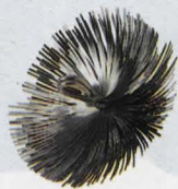
Skorstensviska. Av kupat, hårdat fjäderstål. 150 mm för braskaminer samt rökkanaler med insatsrör 80-150 mm, 230 mm för kanaler 160-230 mm. 350 mm för kanaler 240-350 mm. Svensk tillv. Nr Diam. Pris 30-2710 150 mm ..... 229:- 30-2711 230 mm ..... 249:- 30-4323 350 mm ..... 279:-
