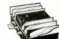
Spänningssomvandlare från 24 V till 12 V, för inkoppling av 12 V radio o. bilstereo på 24 V-system. Kont. 2 A belastning.
