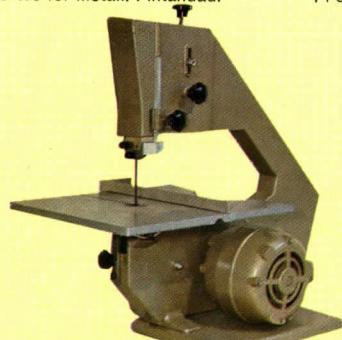
**Bandsåg** BURGESS BBS-20, sågar allt från stål till skumgummi. Ram av gjutet alum.-legering. Bord med ställbart anhåll, 35×30 cm, tippbart för gering intill 45°. Extra tyxt gång. Dim.: längd 600 mm, bredd 350 mm, höjd 550 mm, max sågdjup 300 mm, max såghöjd 75 mm. Vikt 15 kg. Motor 220 V, 1-fas växelström, självsmörjande. Komplett med motor, universalsågblad för trä och metall samt 3 m kabel och stickpropp. Nr 40-70 ..... 595:—
