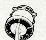
Kopplingsur med stor veckoskiva. Varje vecka-dag kan inställas på ett särskilt program. Kartaste inställningstid 3,5 timmar. Lämplig för oljeeldning och elektrisk uppvärming. Med synkronmotor, självstartande, 48 tim. gångreserv. 220 V. 1-polig. Veckoskiva med 14 ryttrare. Max. 15 Amp. Koppl-hus av pressmassa 19×11×9 cm. Levereras med 4 ryttrare.
