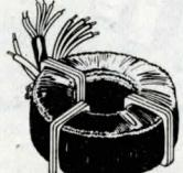
**Transformator** av toroidtyp (ringkärna). Primär: 110, 220 eller 237 V. Sekundär: 11 V/1,2 A 19 V/0,2 A, 19 V/1 A. Okapslad. Inkopplingsanvisn. medföljer. Storlek ca 90×45 mm. Vikt 1 kg. Restparti.
