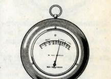
**Hygrometer**, graderad i % relativ fuktighet. Metallskala med kupigt glas i hölje av polerad valnöt. Diam. 12 cm. Nr 34-582 ..... 33:-
