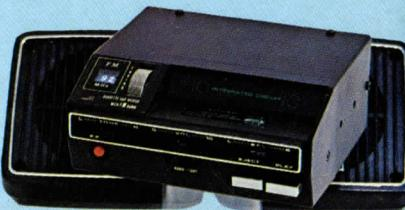
**Bilstereo** med FM radio och stereobandspelare för Philips-kassetter. Tangent för snabb framspolning och kassettkast. Ton-, volym-, och balanskontroll. Utgångseffekt 6 W. Frekvensområde 50–10.000 Hz. Storlek 155×165×70 mm. Vikt 2 kg. Högtalare (32-564/4 ohm) medföljer ej.
