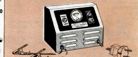
**Batteriladdare**, STAPLES-RALLY. Omkopplingsbar för laddning av 6 eller 12 V bilbatterier med max. 4 A. Med mätinstrument för kontroll av laddningsströmmen. Käpa av lackerad plåt i storlek 19×9×14 cm. Med säkring (22-396-4 A). Endast för 220 V växelström. S-märkt. Med batteriklämmor, sladdar och stickprop. Vikt ca 2,5 kg.
