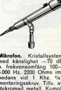
**Mikrofon**, Kristallsystem med känslighet -70 dB o. frekvensomfång 100-5.000 Hz. 2200 Ohms impedans vid 1 Khz. %/av monteringskruv. Tillv. av förkromad metall. Kompl. med halsrem, stativfäste och sladd. Diam. 29 mm.
