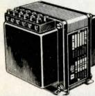
**SPAR-TRANSFORMATOR** för 110, 127 och 220 volt. 50 per. Används då en elektr. apparat för växelström skall anslutas till nät m. annan växelspänning än den apparaten är avsedd för.
