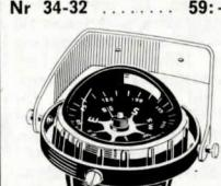
**Båtkompass**. Omställbar för kompensation av metall. Kupat fönster som förstorar indikeringen. Inbyggd 12 belysning för navigering i mörker. Horizontal eller vertikal montering. Kompasshuset i förkromad metall o. glasklar plast. Ringens diam. 11,5 cm, höjd 13 cm. Skalindelning 360°
