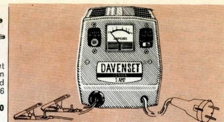
**Batteriladdare**, DAVENSET SENIOR för laddning av 6 och 12 V bilbatterier med 2-5 A från 220 V växelströmsnät. Med säkring och Amp.meter som kontrollerar laddningsströmmen. Storl. 17×15×20 cm. Vikt 4,7 kg. Med ca 1 m anslutningskabel med jordad stickprop samt batterikabel med laddningsklämmor. Mycket kraftig och stabilt byggd. S-märkt.
