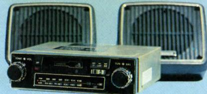
**Bilstereo** TKR CRF-150 M, med FM-stereo och AM mottagning, bandspelare för Philips kassetter. Snabb fram/backspolning, manuell in- och urkoppling av bandspelare, vid urkoppling inkopplas radion automatiskt. Frekvensområde 50–10.000 Hz -6 db. Bestyrckning: 26 transistorer, 2 IC-kretsar, 12 dioder. Rattar för ton, volym och balanskontroll. Utteffekt 2x 4 W. Högtalare (32-564/4 ohm) medföljer ej. Storlek 180×156×50 mm. Endast för 12 V neg. jord. Vikt 2,3 kg.
