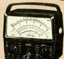
**Universalinstrument**, typ HIOKI-A-10. Ett precisionsinstrument av högsta klass. Synterligen lämpigt för radio och ljudservice, försedd m. inbyggd övertonsrör. Tongenerator för testing av LF, MF o. HF-kretsar. Inbyggt överbelastningsskydd för vridspolen.
