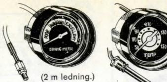
**35-59. Vakuummätare**. Visar undertryck i motorns inloppsrör och därmed motorns tillstånd. Anslutningsslang med 1/4" anslutning medf. Inbyggd belysning med 12 V lampa. Diam. 52 mm. 6 V lampa (22-643).
