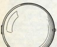
Urglas med ram o. gångjärn av blankpolerad mässing. Kupigt glas diam. 180 mm.
