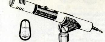
**Kondensatormikrofon**, typ EX-220. En Elektret kondensatormikrofon av hög klass och med ett elegant utförande. Försedd med inbyggd FET-transistorförstärkare som matas med ett 1,5 V batteri (UM3).
