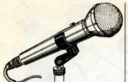
**Mikrofon.** Dynamisk TEISCO DM-109. Helt tillverkad i mattpolerad metall och försedd m. ström. brytare. Imped. 50 Kohm. Frekvensomr. 100—10.000 p/s. Känslighet —60 dB. Storlek 165×40 mm. Levereras med ca 1,6 m ledning samt fäste med 16 mm jap. standardgång för stativ.
