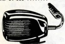
**Mikrofon.** Dynamisk handmikrofon (DM-501) med tumkontakt (press-to-talk). En tålig mikrofon i kraftigt metallhölje och med ca 2 m spiralsladd. Känslighet —58 dB. Frekvens 150—10.000 p/s. Imp. 50 K ohm. Vikt 300 g.
