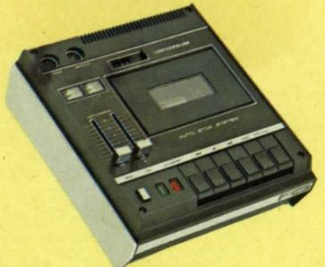
**Stereokassettdäck SELECT 794**, för anslutning till förstärkare, 6 tangenter för in/avspelning, snabbspolning fram/back samt stopp. Försedd med automatiskt stopp vid slutspelat band, 2 st VU-meter samt skjutpotentiometer för kontroll av inspelningsnivån. Räkneverk. DIN-anslutning för mikrofon, hörlurar och linje. Data: frekvensområde 70–10.000 Hz. Ing. mikrofon 0,15 mV, linje 0,15 mV, utgång 0,9 V. Storlek 206 × 228 × 82 mm, vikt 2,5 kg. S-märkt 220 V.
