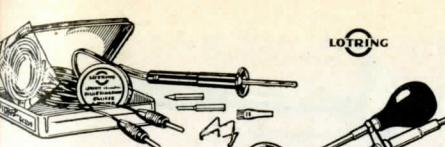
**Lödsats** **PICOPEN** för svagström. Innehåller lödpenna med sladd, lödtenn och lödsalva jämför mässingborste och stativ. Allt förvarat i plåtask i storl. 80×110×25 mm. Ett litet utmärkt verktyg för radio o. finmekanik. Som strömkälla används bilbatteri el. transformator. Strömförbrukning 15 watt. Finns för 6, 12 eller 24 V. Uppgiv spänning vid order.
