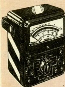
**Universalinstrument**, typ HT-100. Ett högklassigt universalinstrument utrustat med ett 9,5  $\mu$ A högkänsligt vridspoleinstrument med stor spegelskala. Robust och oömt med stötsäker vridspole och m. överbelastningsskydd. Omkopplare på panelen för inkommande polaritet. Med kraftigt läderhandtag och testsladdar. Mätområden:
