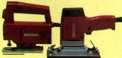
**Sticksåg**, Metabo, Expert, med dubbelisolering universalmotor 220 V. Effekt 320 W in. Två hastigheter 2200/3000 slag/min. i tomgång. Max. sågdjup i trä 40 mm. Fotplattan kan ställas i vinkel intill 45°. 3 Sågblad medföljer. Vikt 1,7 kg.
