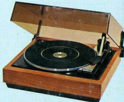
**Skivspelare BSR P 128.** En helautomatisk skivspelare som uppfyller DIN-normerna. Hydraulisk dämpad tonarmsnedläggning. Fjäderupphängt chassi. Gjuten skivtallrik, vikt 1,4 kg. Rökfärgad plasthuv. 1,5 m ledning med 5 pol. DIN-kontakt. Levereras med SHURE pickup typ M 75-6 S. Betrf. data, se pickup 373. 220 V S-märkt. Storlek 37×35×17 cm. Vikt 6,5 kg. Lådan av teak, palisander eller valnöt.
