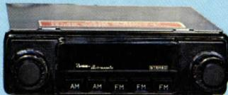
**Bilradio** BOMAN en högautomatiserad radioenhet för stabil mottagning med utmärkt känslighet. Snabbinställning för 3 FM och 2 AM program. Frontrönt standard typ passande radiotagg i bilen. Säkerhetsrattar av gummi. Volym- och tonkontroll. Minus-jord. Utteffekt 6 W. Storl. 170×50×160 mm. Monteringsdetaljer, störningsskydd och oval högtalare medföljer. Endast 12 V.
