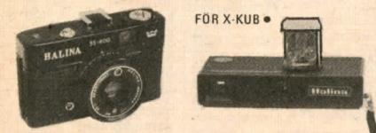
**Kamera** HALINA 35-600. En automatisk kompakt-kamera för småbildsfilm, 36 exponeringar 24×36. Skarpecknande optik med ljusstyrka 2,8/40 mm. CdS-mätare ger automatiskt perfekt exponering. Tidsvariation 1/40—1/200 sek. Endast avståndsställning behövs. Mjukt toppavtryck. Blixtsko med mittkontakt, men även nippel för blixtsladd. Med väska och handrem. Utan batteri (PX-625).
