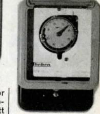
Kopplingsur för 220 V, m. ett eller två till- och frånslag, ställbara dynget runt. Fjäderverk m. 8 dagars gångtid o. graderat ruckningsställverk. Ut-märkt precisionsur med noggrann gång. Max. 10 Amp. Gråläckerad kraftig plåtlåda 13×10×8 cm. Levereras med 4 ryttrare.
